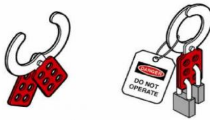
۴. نمونه ای از سیستم lag out/tag out
