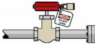
۵. نزدیک ترین شیر به مخزن بایستی بسته و برجسب به آن متصل گردد.
