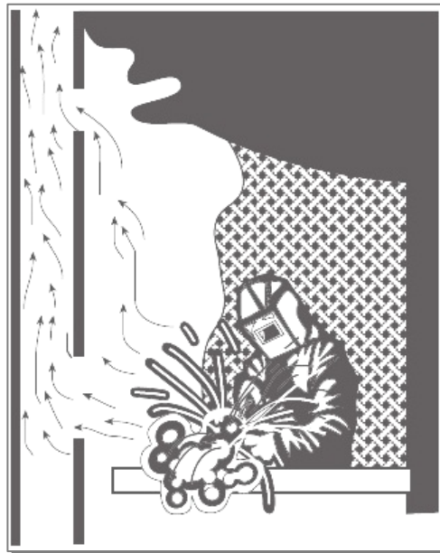
شکل ۱۵-۲- تهویه هوای داخل کابین هنگام جوشکاری
