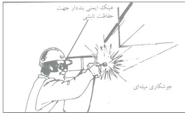
شکل ۴-۴- استفاده از عینک ایمنی بنددار یکپارچه جهت حفاظت تابشی با درجه تیره‌گی متوسط
