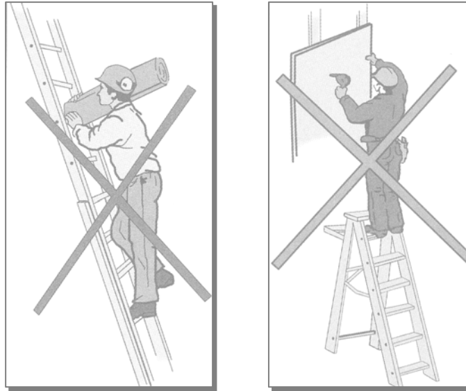
ادامه شکل ۱۸-۴- برخی نکات ایمنی استفاده از نردبان
