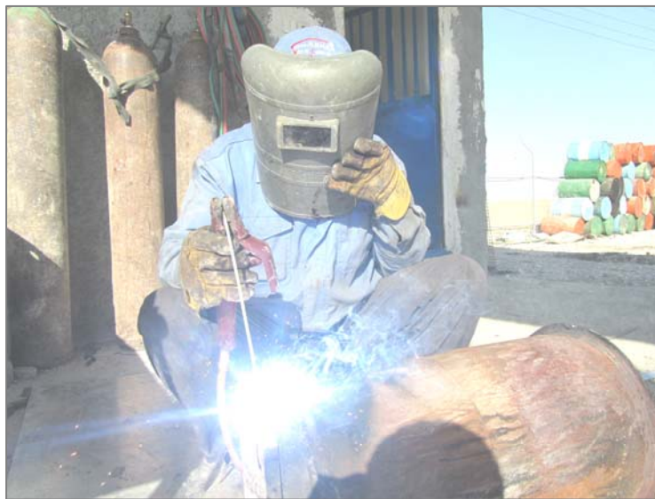
شکل ۱۵-۴- استفاده از تمامی وسایل ایمنی در حین جوشکاری
