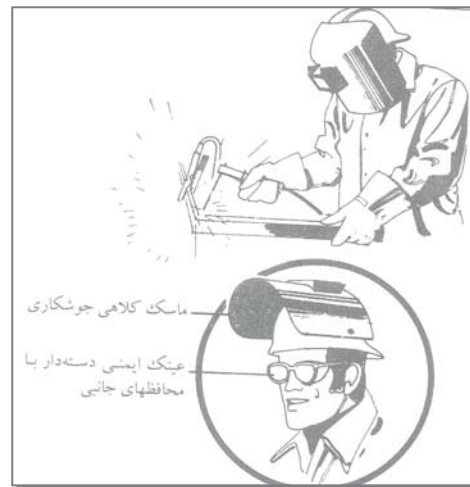
شکل ۴-۱- استفاده از عینک ایمنی دسته دار همراه با ماسک محافظ جوشکاری و دستکش محافظ
