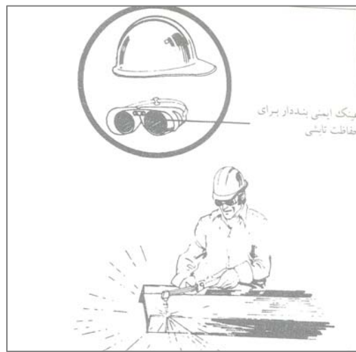
شکل ۴-۵- استفاده از عینک ایمنی بنددار یکپارچه جهت حفاظت تابشی با عدسی با درجه تیره‌گی زیاد
