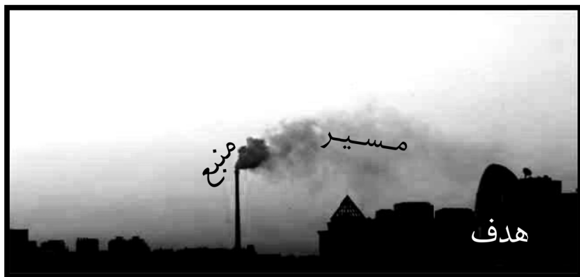
شکل ۴-۷۶ - آلودگی از منبع دودکش بر می‌خیزد و از مسیر هوا به هدف که منازل مسکونی باشند می‌رسد.
